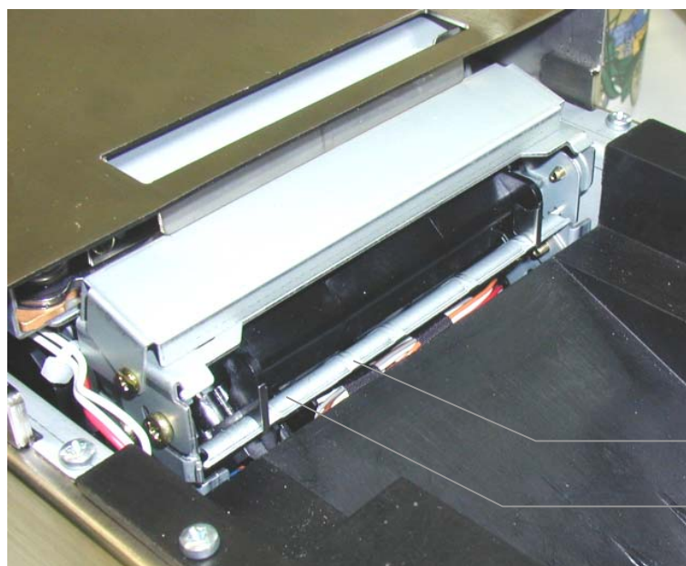
Abb. 4 – Papierfach bei geöffnetem Papierdeckel
